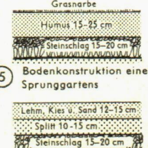
⑤ Bodenkonstruktion eines Sprunggartens
